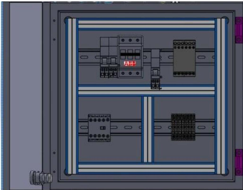
Figura 17, Vista frontal del gabinete de control eléctrico.
