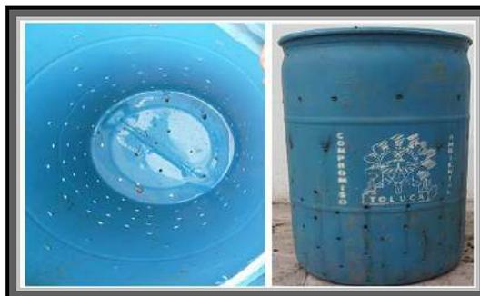
Figura 2.4 Filtro para eliminación de humedad en RSO
