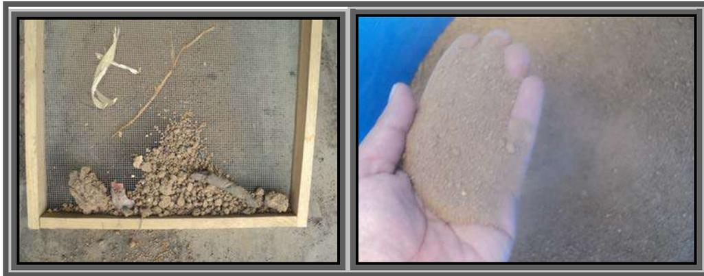
Figura 2.5. Eliminación de impurezas y homogenización de la arcilla
