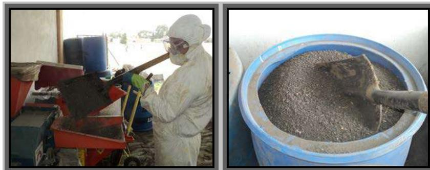
Figura 2.2. Triturado y cribado de biosólido.
