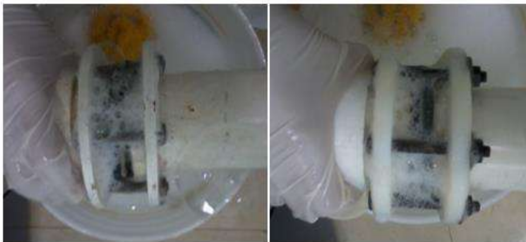
Figura A.2 Pruebas de hermeticidad a) con fuga, b) sin fuga
