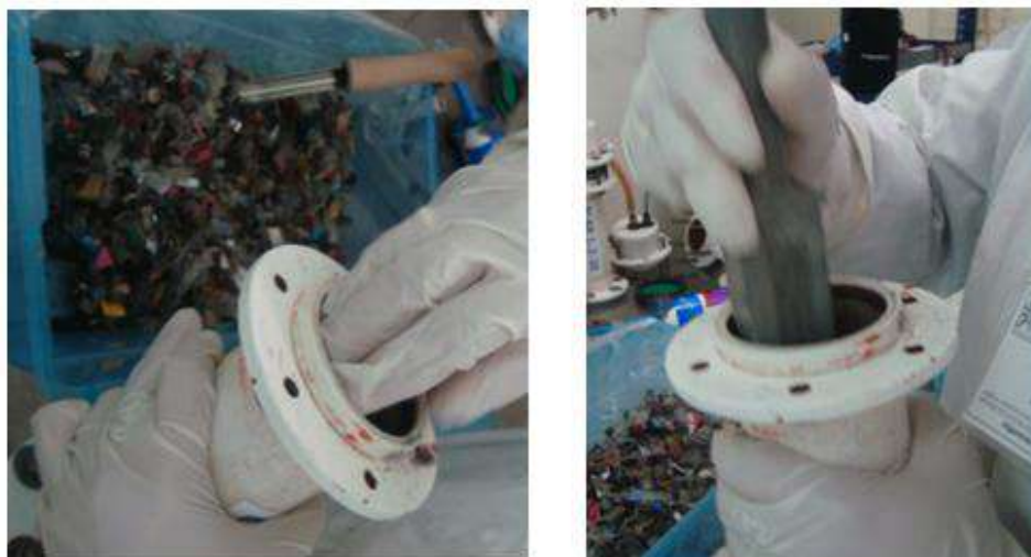
Figura A.8 Llenado de biorreactor con mezcla de RSU.
