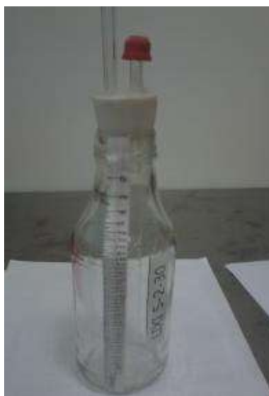
Figura A.5 Sistema para captación de lixiviados.
