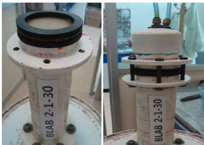
Figura A.10 Colocación de empaques superiores y domo en el BLAB.
