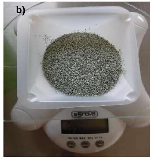
**Figura 3. 2.** Zeolita Z<sub>OXa</sub> antes a) y después b) de la molienda y tamizado.
