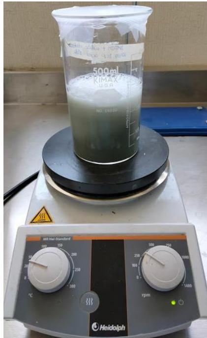
Figura 2.4 Modificación del material zeolítico con el surfactante
