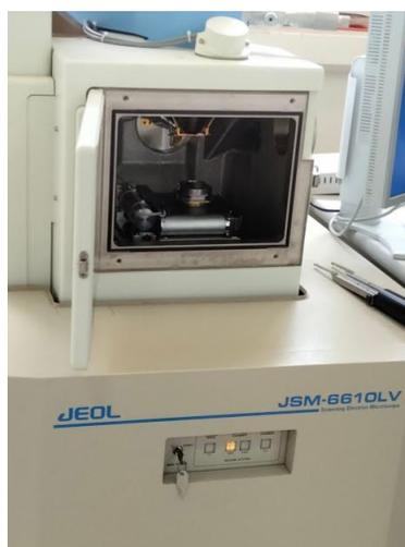
Figura 2.5 Microscopio electrónico de barrido empleado en la caracterización del material
