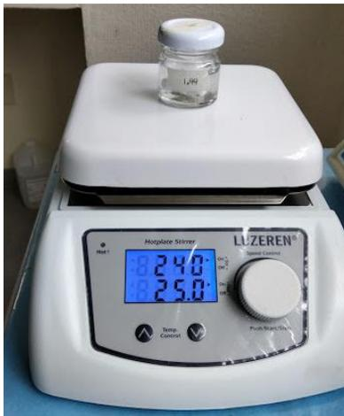
Figura 2.6 Solución ajustada a pH 2 para la obtención del PCC
