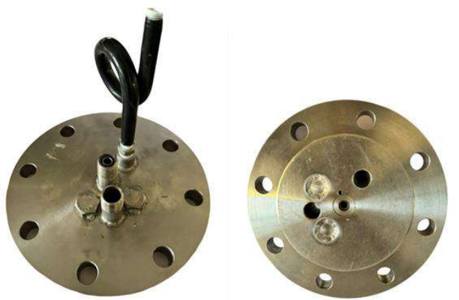
Figura 3.11. Tapa del reactor modificada.
