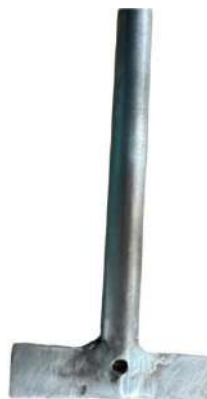
Figura 3.12. Agitador de dos palas fabricado en acero inoxidable.
