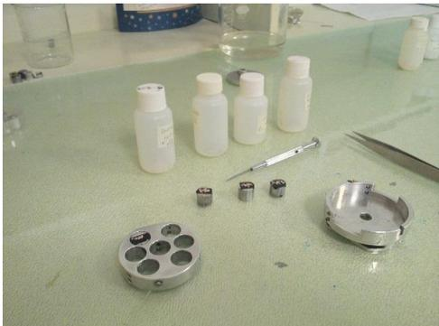
Figura 2.2 Colocación de muestras para la observación por MEB.
