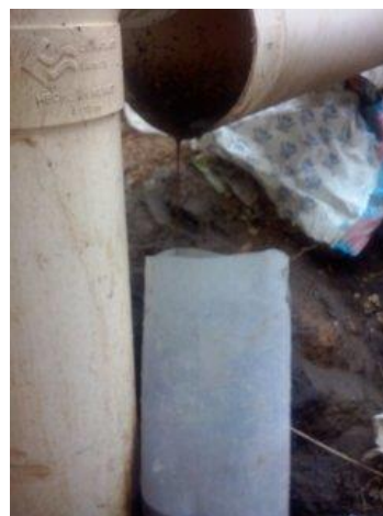
Figura 3. 12 Toma de muestra de lixiviados en los tres SDF.
