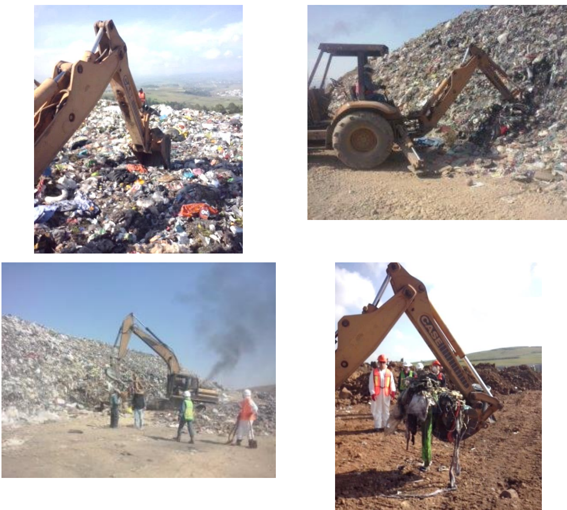
Figura 3. 6 Toma de muestra de RSU en ZIN
