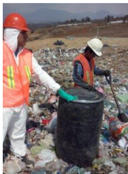
Figura 3. 7 Toma de muestra de RSU en VG
