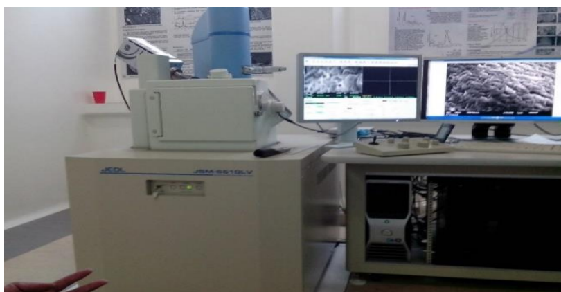
Figura 2.5. Microscopio electrónico de barrido
