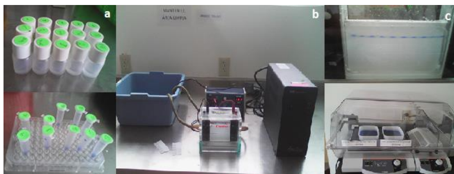
Figura 2.8 a) Muestras, b) equipo de electroforesis, c) corrimiento de las proteínas y tinción
