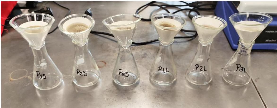
Figura 3.22 Filtrado de la muestra después de la extracción con DTPA
