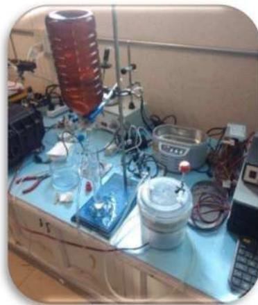
Figura 3.5 Recipiente de extracción de gases en funcionamiento
