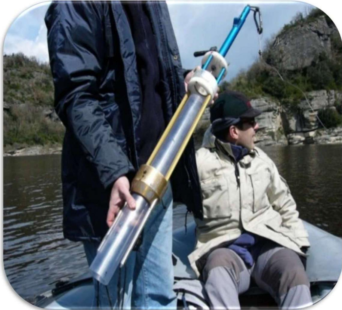
Figura 1.4 Muestreador tipo núcleo (Salazar y Peñuela, 2010)
