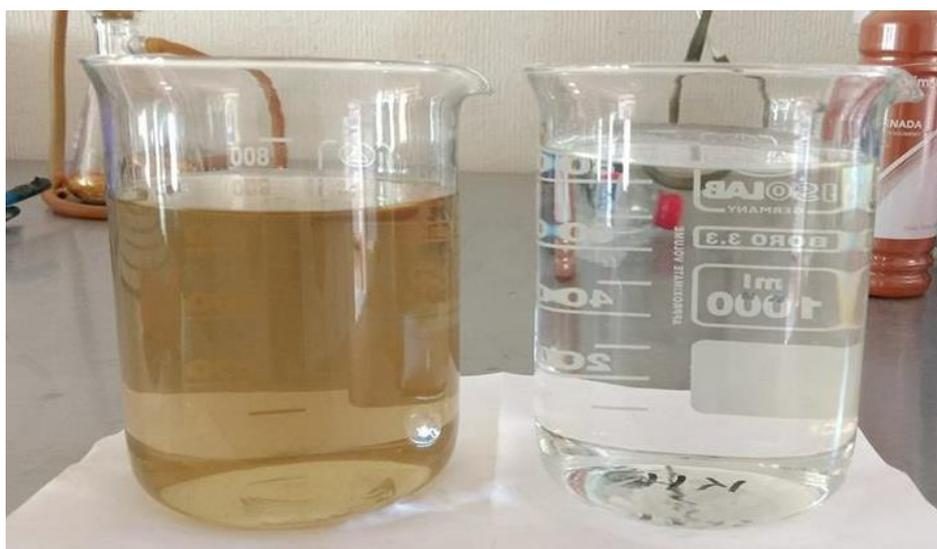
Figura 3.4 Efluentes fenólicos posteriores al tratamiento, concentrado y permeado.
