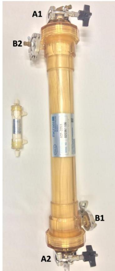
Figura 2.14. Módulos de membrana, a escala laboratorio (izquierda) y piloto (derecha).
