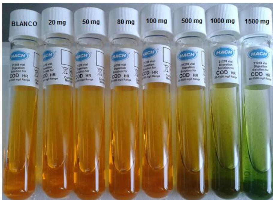
Figura 2.3 Coloración de los tubos ocupados para la determinación de DQO.
