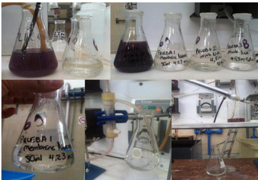
Figura 3.2. Permeados y concentrados obtenidos de las diversas experimentaciones escala laboratorio.
