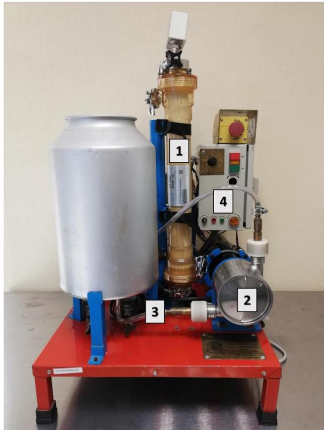
Figura 2.15. Equipo de tratamiento de ultrafiltración escala piloto.
