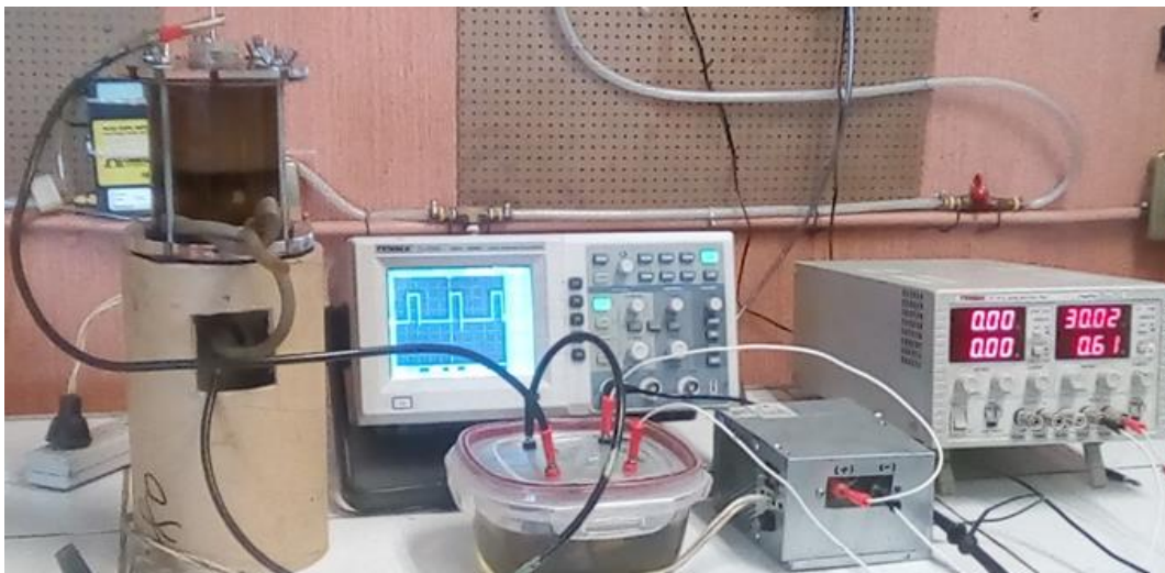
Figura 3.3 Tratamiento de películas con plasma de descarga luminiscente.
