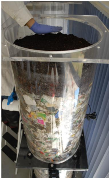
Figura 2.14 Colocación de la cobertura
