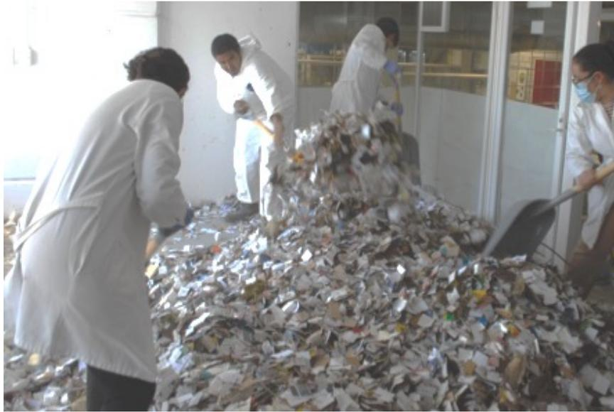
Figura 2.6. Homogenización de la mezcla sintética
