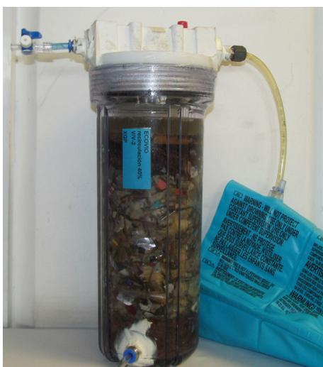
Figura 2.29 Biorreactor después de la recirculación
