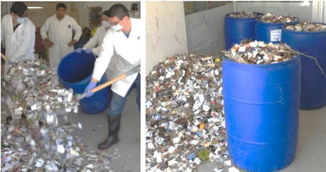
Figura 2.7 División de la mezcla en tres partes iguales
