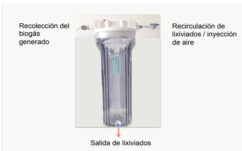
Figura 2.23 Partes del biorreactor
