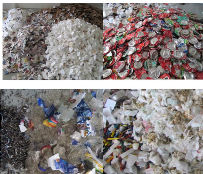
Figura 2.4 Componentes inorgánicos de la mezcla sintética
