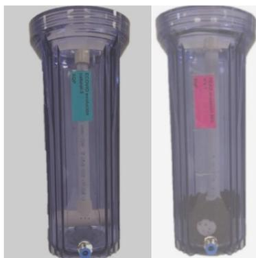
Figura 2.27 Biorreactores con tubos de PVC con perforaciones
