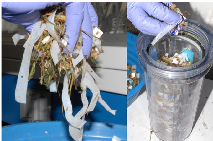
Figura 2.26 Llenado de biorreactor
