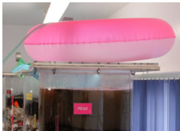
Figura 2.20 Recirculación de lixiviados del lisímetro de PEAD
