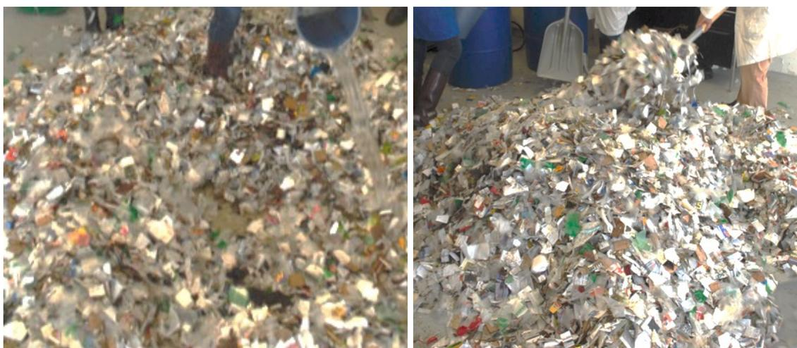
Figura 2.9 Mezcla de los residuos con la adición del agua
