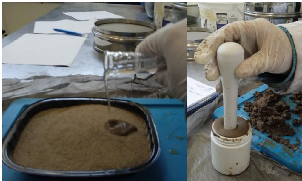
Figura 2.5 Pruebas para la determinación de límite líquido y plástico.
