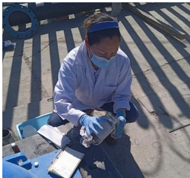
Figura 3.52 Muestreo de agua en pozos
