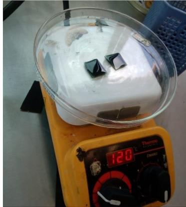
Figura 2.21 Depósito de PANI a temperatura controlada.
