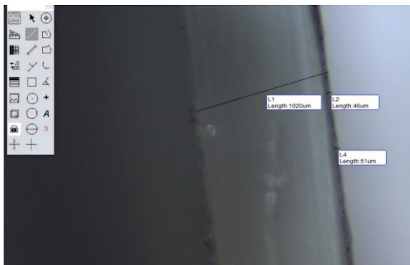
Figura 3.8 Medición del tamaño del espesor de la película de PANI.
