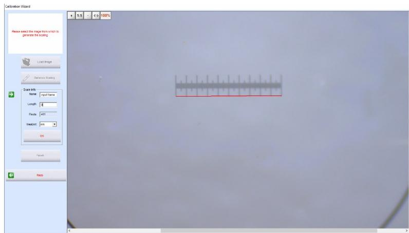
Figura 3.6 Calibración de pixeles con una escala de 1mm por medio de un microscopio estereoscópico.
