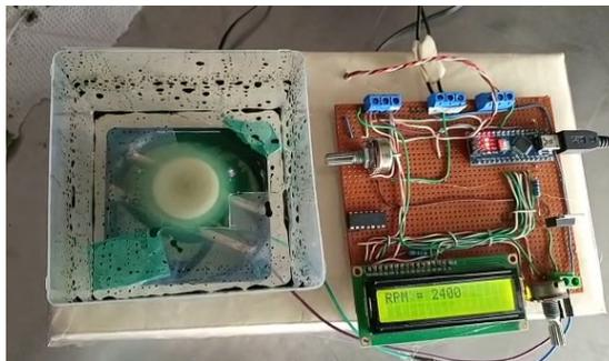
Figura 2.13 Formación de películas delgadas por spin coating.
