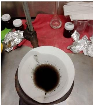
Figura 2.5 Lavado de polianilina obtenida por oxidación.
