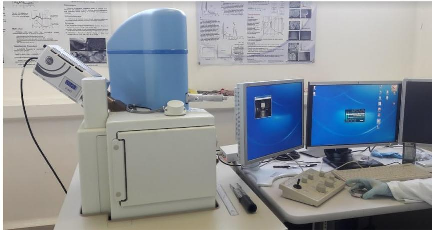
Figura 1.19 Microscopio electrónico de barrido JEOL JSM 5900 LV instalado en el Instituto Tecnológico de Toluca.
