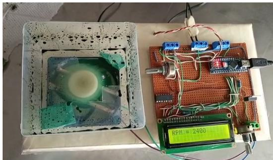
Figura 2.17 Método de spin coating para el desarrollo de películas delgadas de polianilina.
