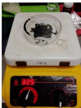
Figura 2.6 Secado de polianilina mediante una parrilla de agitación.
