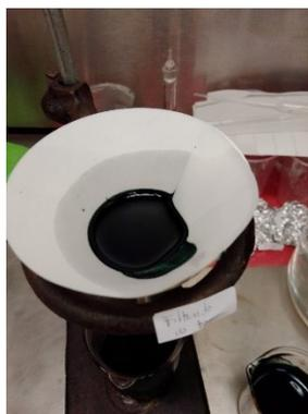
Figura 2.4 Filtrado de polianilina obtenida por oxidación.
