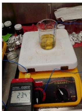
Figura 2.2 Adición del monómero (anilina) mediante una pipeta gota a gota en la solución.
