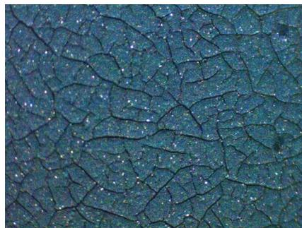
Figura 3.5 Vista de una película por la técnica de drop casting a través de un microscopio estereoscópico.
