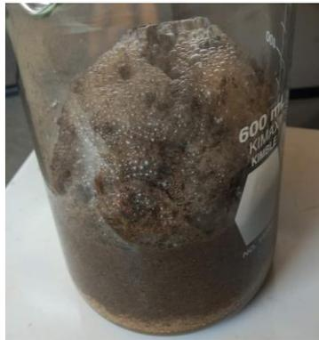
Figura 3.11 Muestra de suelo de Metepec tratada con peróxido de hidrógeno
