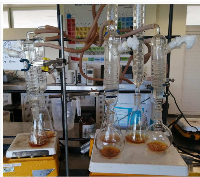
**Figura 3.4:** Montaje del equipo de destilación para la determinación de la DQO.
