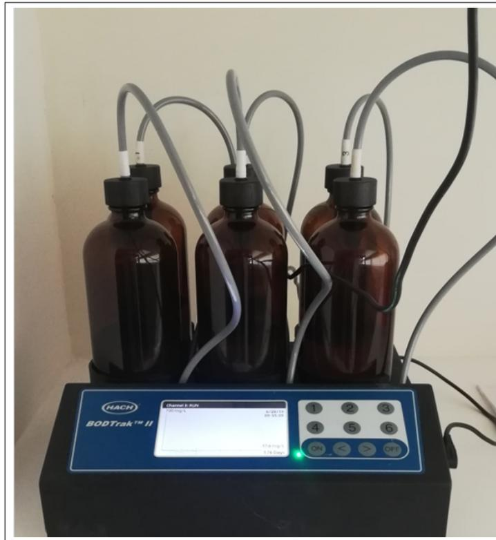
**Figura 3.6:** Equipo BOD Track II HACH utilizado para la esta determinación.
