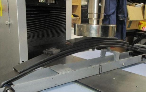
**Figura 3. 3 Prueba del banco en máquina universal.**
