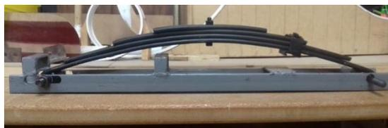
**Figura 3. 1 Propuesta conceptual de banco experimental.** **Figura 3. 2 Muelle montado en soporte fabricado.**
