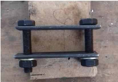
**Figura 3. 7 Abrazadera para precarga del muelle.**
