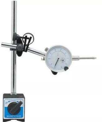
**Figura 2. 12 Montaje de un indicador de cuadrante.**
