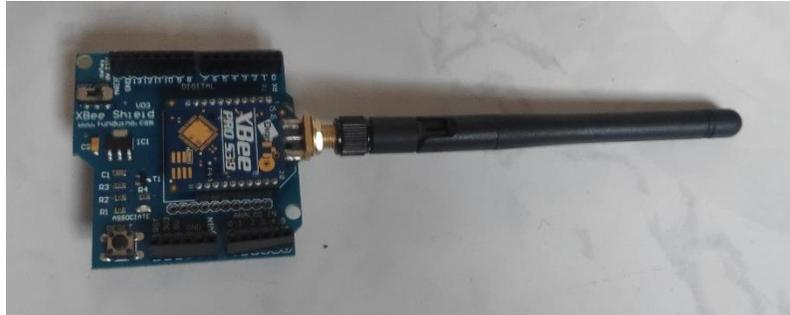
Figura 25: Tarjeta electrónica Xbee S3B
