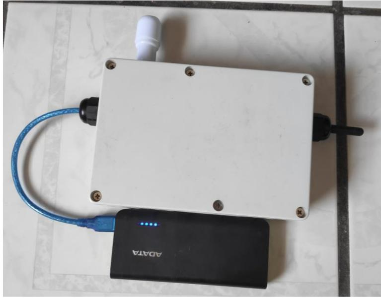
Figura 29: Nodo sensor terminado y alimentado por la power bank
