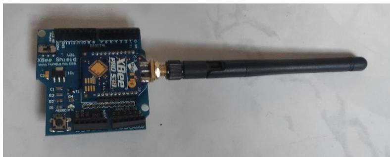
Figura 33: Tarjeta Electrónica S3B PRO
