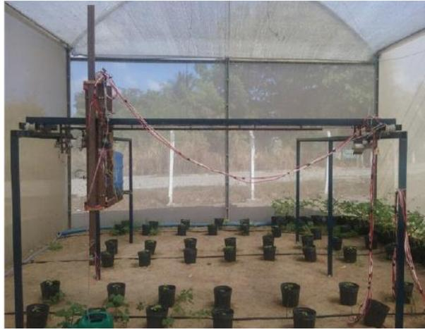
**Figura 6:** Prototipo de robot agrícola multifuncional de bajo costo. (Batista, y otros, 2017)
