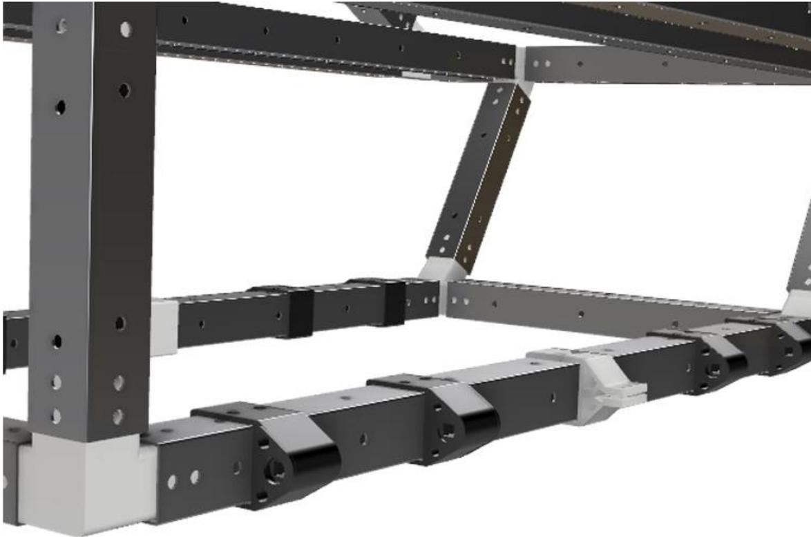
**Figura 32:** Soportes móviles (gris oscuro) y fijos (blanco) para la barra de torsión.
