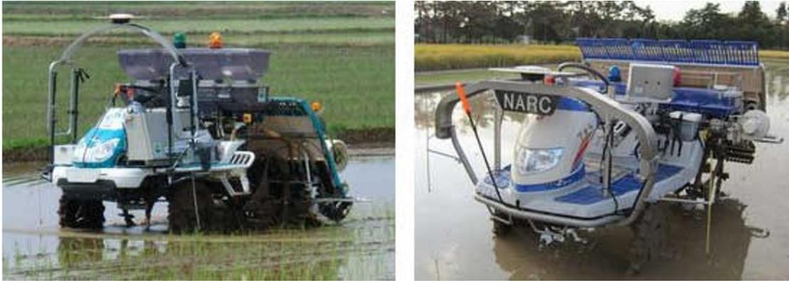
**Figura 11:** Robot trasplantador (Tamaki, y otros, 2013).
