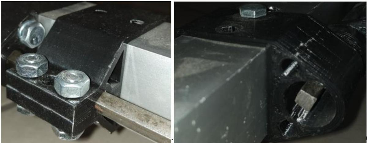
Figura 43: Soportes para el sistema de suspensión del UGV agrícola.
