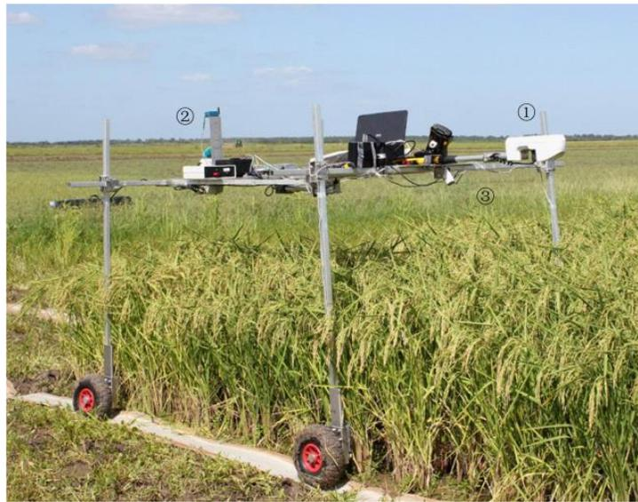
**Figura 8:** Plataforma UGV equipada con sensores, trabajando en los campos de arroz (Pei, y otros, 2014)
