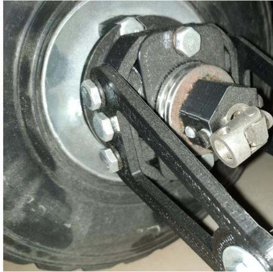
**Figura 44:** Ensamblaje masa-rueda del UGV agrícola.
