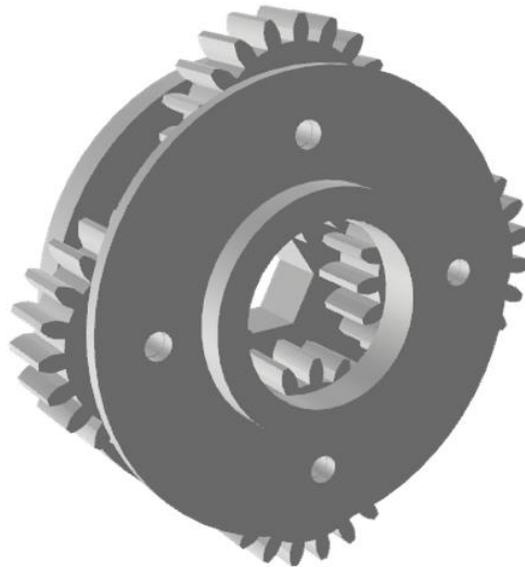
**Figura 40:** Porta-Planetas del ensamblaje motor-reductor.
