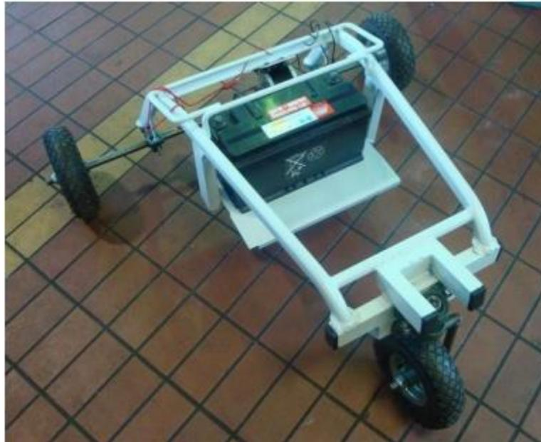
**Figura 1:** Prototipo KERVEROS, un UGV empleado en la vigilancia de terrenos (Fofilos, Xanthopoulos, Romanos, Zikidis, & Kanellopoulos, 2014)
