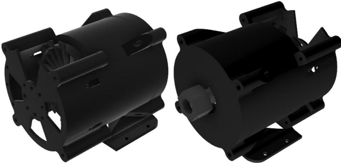
**Figura 39:** Exterior del ensamblaje motor-reductor.
