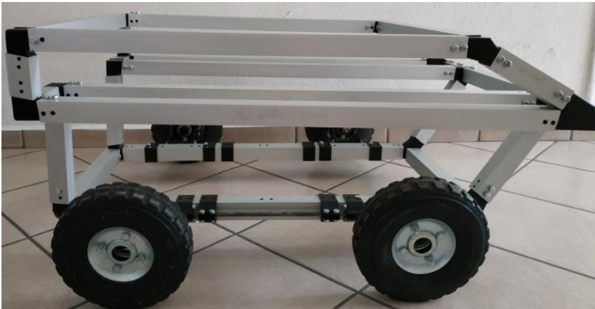
Figura 42: Chasis ensamblado del UGV agrícola.
