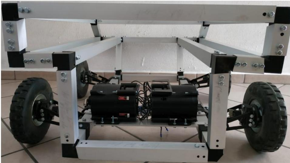
Figura 48: Componentes del tren motriz montados en el chasis del UGV agrícola.
