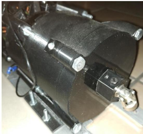
**Figura 45:** Ensamblaje motor-reductor del UGV agrícola.
