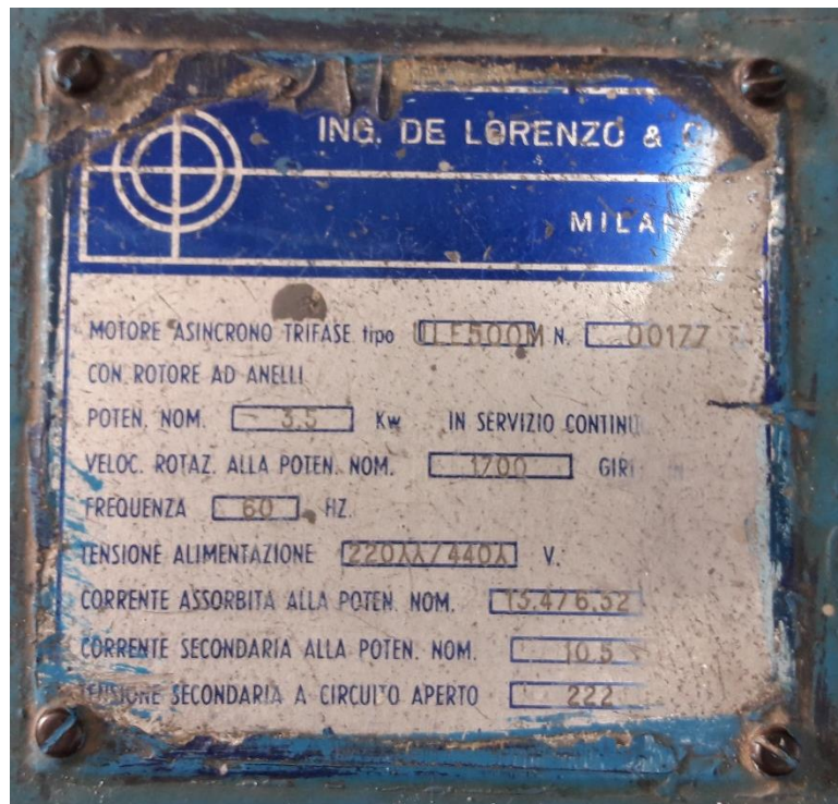
Figura 4.13 Datos de placa del motor de inducción.
