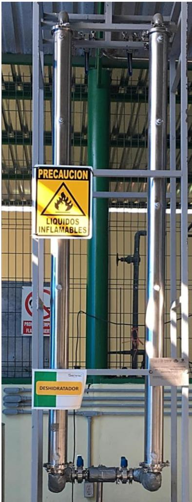
Figura 5.15 Columnas de adsorción a nivel planta piloto
