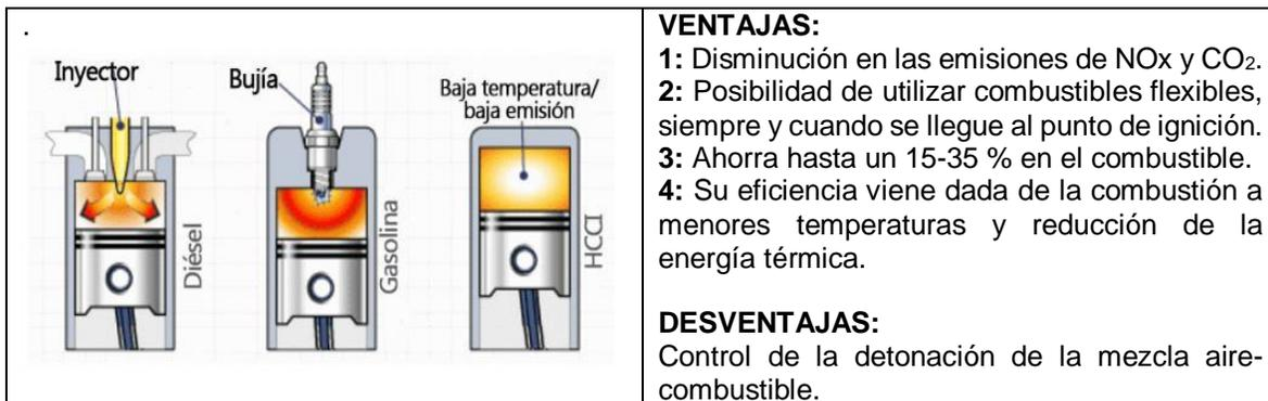
Figura 2.1 Proceso de combustión dentro de un motor HCCI (Prince, 2018-3).
