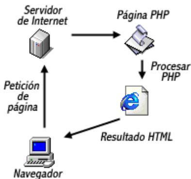
Figura 2.10 Diagrama de bloques PHP.
