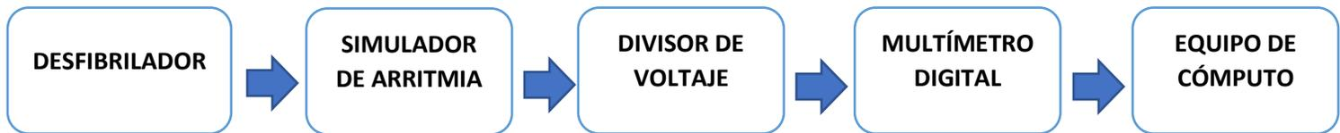
Fig. 17: Diagrama del sistema para determinar voltaje del pulso de desfibriladores
