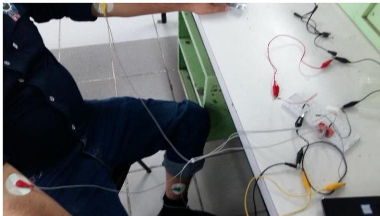
Fig. 8: Sistema para obtener señal ECG [20]
