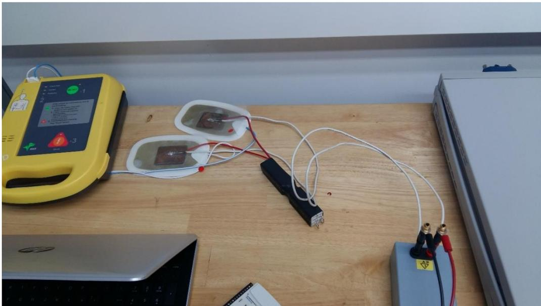
Fig. 18: Conexión en paralelo entre desfibrilador, resistencia, divisor de voltaje y DAQ
