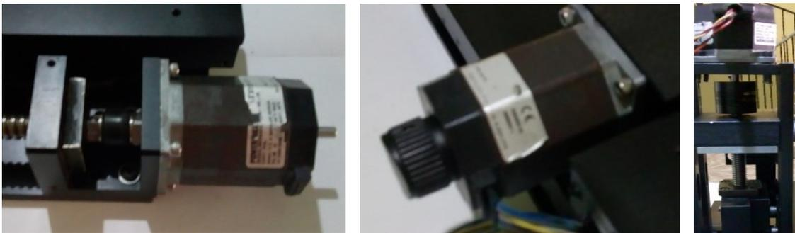
FIGURA 74. ACOPLAMIENTO DE EJES
