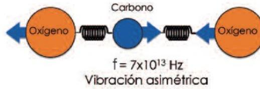
FIGURA 8. VIBRACIÓN ASIMÉTRICA
