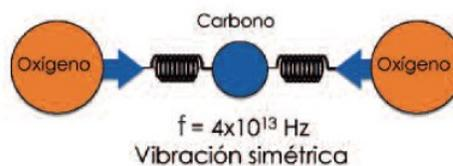
FIGURA 6. VIBRACIÓN SIMÉTRICA
