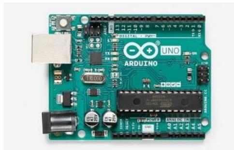
**Figura 7.15** Arduino UNO, microcontrolador.
