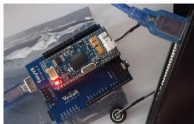
**Figura 9.14 Conexión modo PC de microcontrolador y módulo EasyVR 3.**
