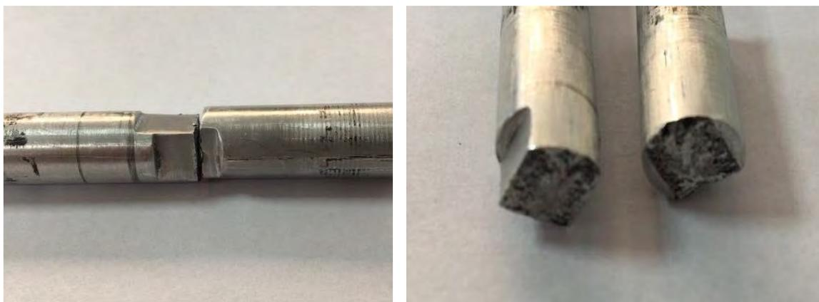
Figura A.4 Fractura de la flecha de aluminio para  $n = 145617$  ciclos.
