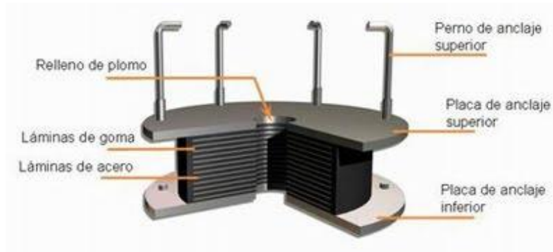
Figura 1.6 Amortiguador de placas de goma con núcleo de plomo [43].
