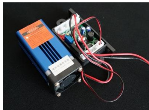
Figura 5.20. Láser 1W 850 \mu\text{m}
