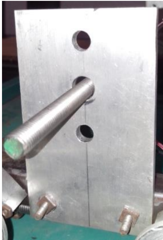
Figura 6.8. Base para el Motor Nema 23 eje Y
