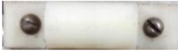
Figura 6.10. Acoplamiento para las guías del eje Y
