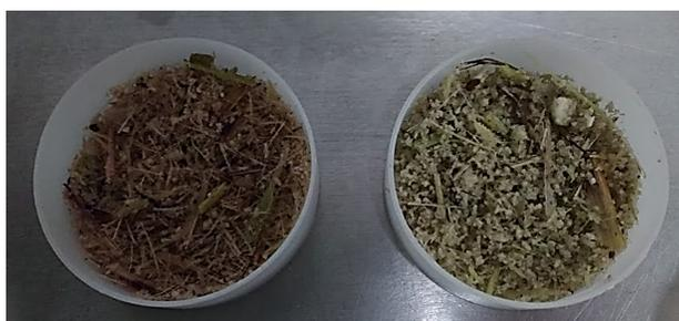
**Figura 7.6.** Muestras de sorgo dulce triturado utilizadas en FES, a la izquierda muestra esterilizada, y a la derecha muestra no esterilizada.
