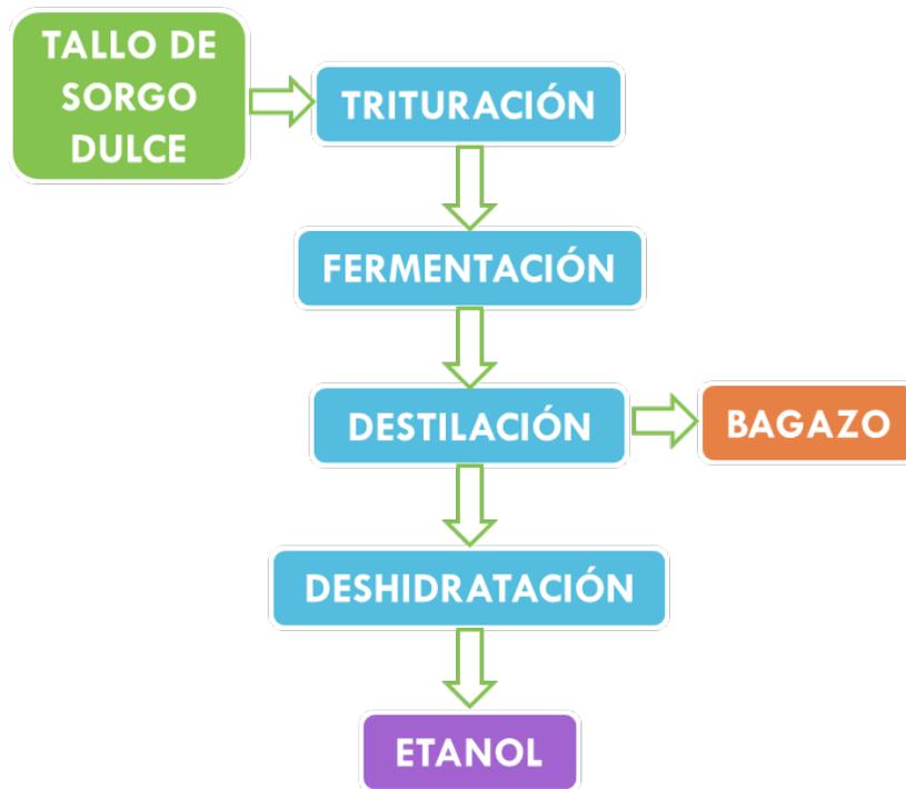
**Figura 2.3.** Diagrama de proceso para la producción de etanol de sorgo dulce utilizando FES.
