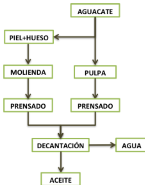
Figura 2.5.- Diagrama de extracción de aceite de aguacate por prensado con y sin hueso molido (Martínez et al. , 1988).
