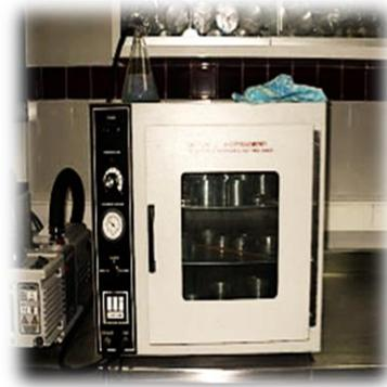
FIGURA 4.2. Contenido de sólidos en el extracto a) extracto evaporado en rota evaporador, b) Refinado en horno de vacío.
