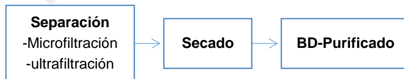
FIGURA 3. Purificación de biodiesel con tecnología de membranas.
