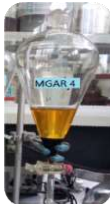
FIGURA 15. Separación de las fases éster-glicerol obtenidas de la transesterificación de la mezcla de grasas y aceites residuales (MGAR 4).
