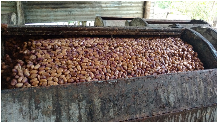
Figura 16: Modalidad de Fermentación del grano de cacao en Tambor Rotatorio
