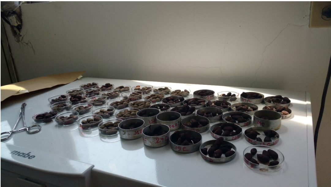
Figura 52: Determinación de humedad por pérdida de peso de las muestras de cacao
