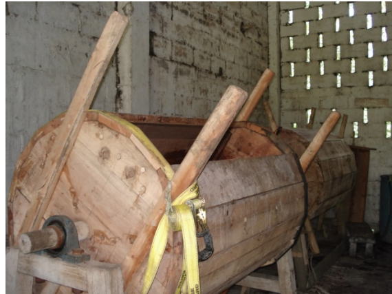
Figura 15: Tambor rotatorio ocupado para fermentación del grano de cacao
