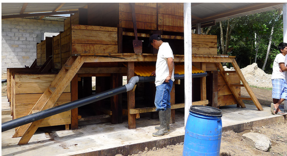
Figura 17: Modalidad de Fermentación del grano de cacao en cajones escalonados
