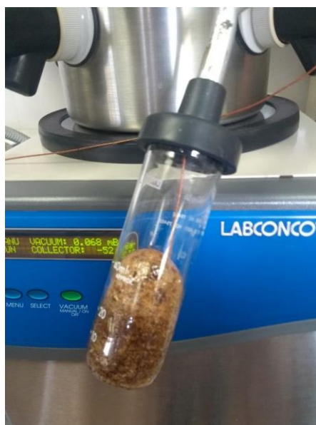
FIGURA 4.3 Liofilización del extracto de vainilla con supervisión de la temperatura
