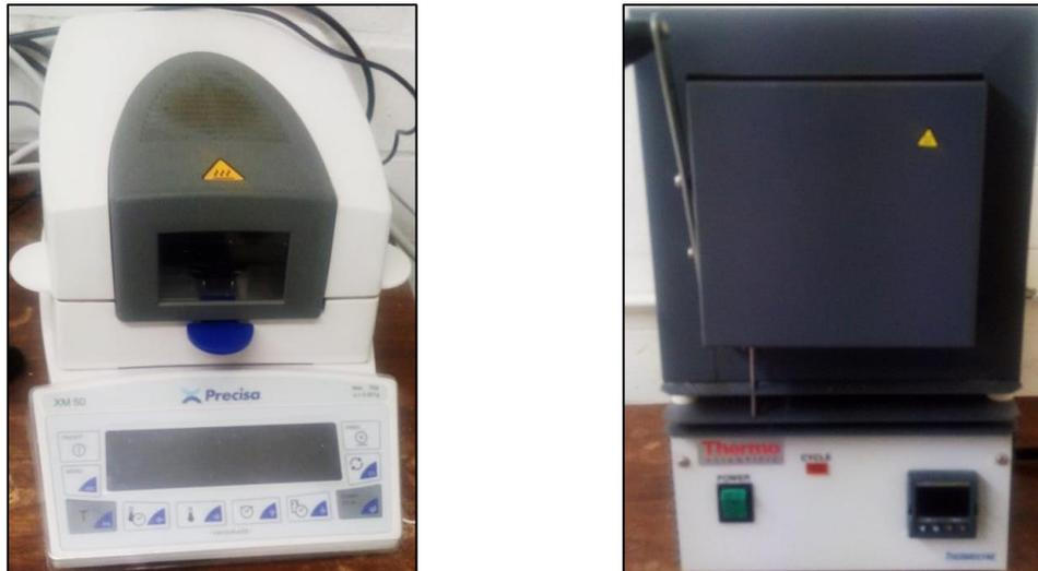
**FIGURA 4.4.** Termobalanza Precisa XM 50 y Mufla Thermo Scientific FB1415M.
