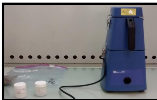
Figura 2.6 Molino eléctrico M20 IKA-WERKE usado en la preparación de muestras vegetales
