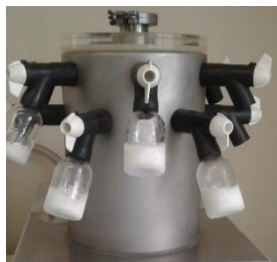
Figura 2.6 Liofilización de criogeles Q-TPJ-AI 15%.
