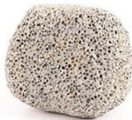
Figura 1.7 Estructura porosa del tepojal.
