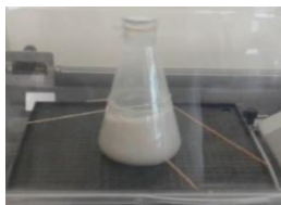
Figura 2.4 Mezcla tepojal- \text{Al}_2(\text{SO}_4)_3 .
