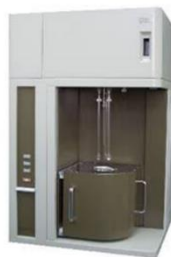
Figura 2.10 Instrumento para la medición del área superficial específica.
