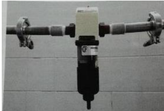
Figura 1.6. Filtro Speedy o filtro tamiz de 100\mu . Fuente: (Anaya, 2017).
