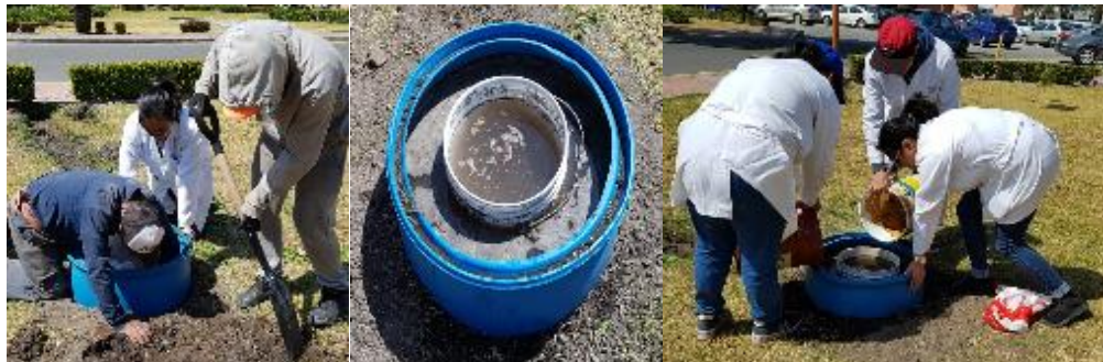
Figura 3.18 Prueba de infiltración de doble anillo.
