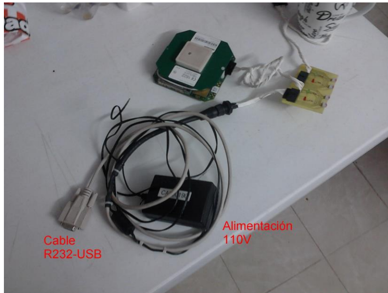
Figura 8.6 Conexión de cable de pruebas para DMR800D OEM
