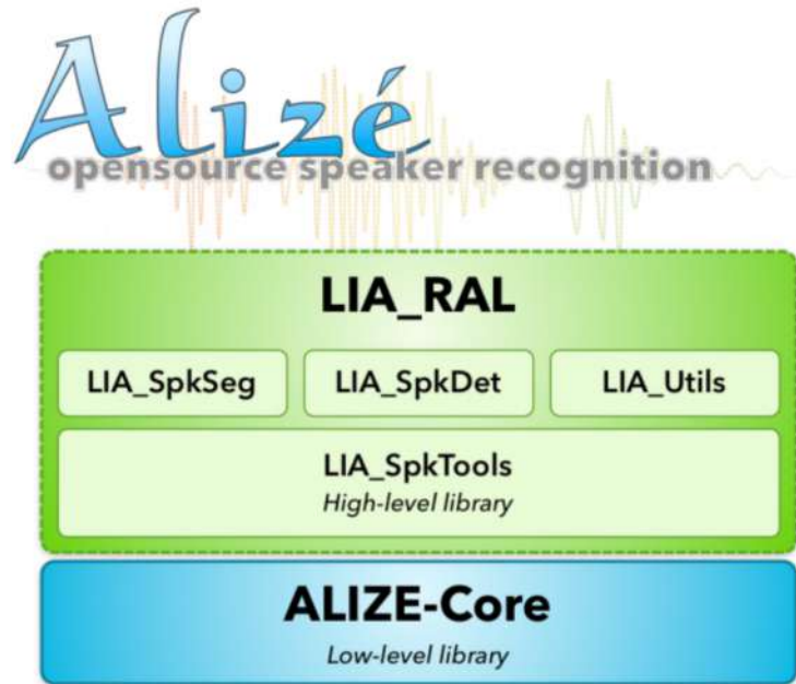
Figura 2.4: Estructura de ALIZE [Pérez Pascual, 2017].
