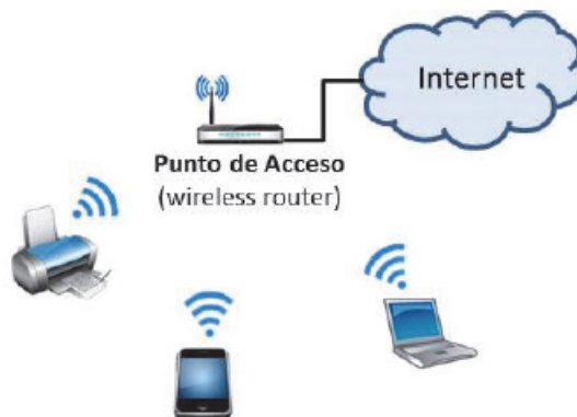
Figura 3.3: Esquema de una WLAN en el hogar.
