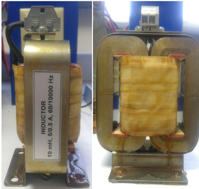
Figura 4.2: Inductor  $L_g$  con núcleo de hierro amorfo.
