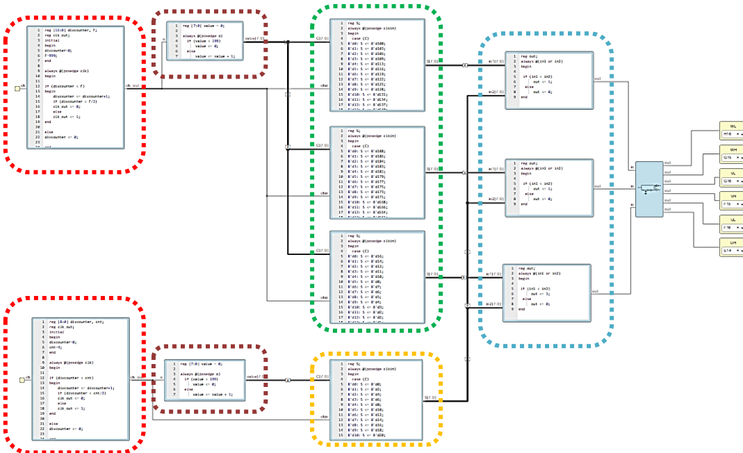
Figura 3.34.- SPWM en lazo abierto en icestudio con FPGA iCE40-HX8K.
