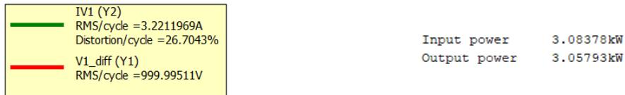
Figura 3.19 Parámetros de la corriente y tensión de entrada.
