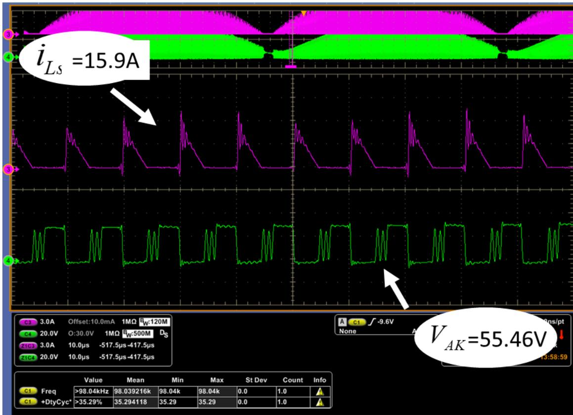
Figura 4.16 Corriente del secundario del transformador, señal superior y voltaje  $V_{AK}$  señal inferior
