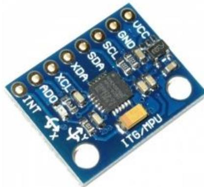
Figura 31 Modulo MPU6050
