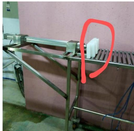
Figura 43. Soportes del pistón de empuje
