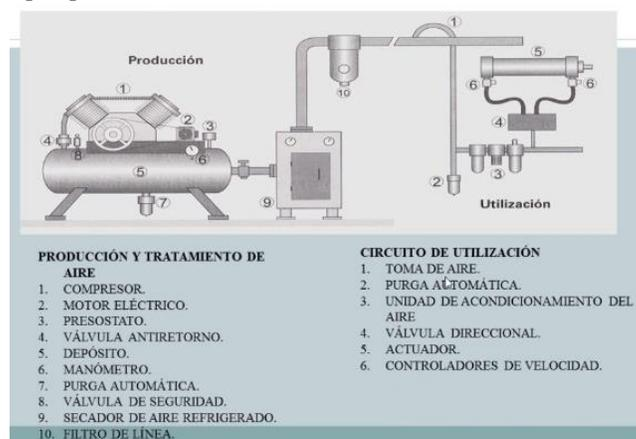
Figura 12. Sistema neumático.
